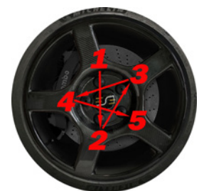
7a. Proper Lug Tightening: Cross Pattern
